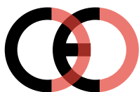
Faux marquage CE (trop proche)
