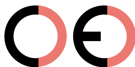
Faux marquage CE (trop éloignée)
